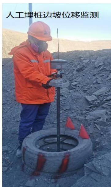
照片3-15 （人工埋桩边坡位移监测）
